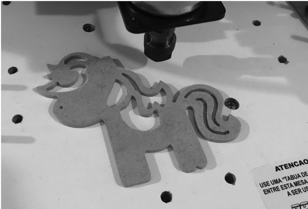
Se todas as configurações foram feitas conforme este manual, ao fim da usinagem o motor irá voltar ao ponto zero e a peça estará pronta.
